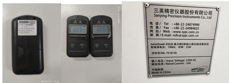
配备辐射巡测仪和个人剂量报警仪 工业 X 射线 CT 机标牌
