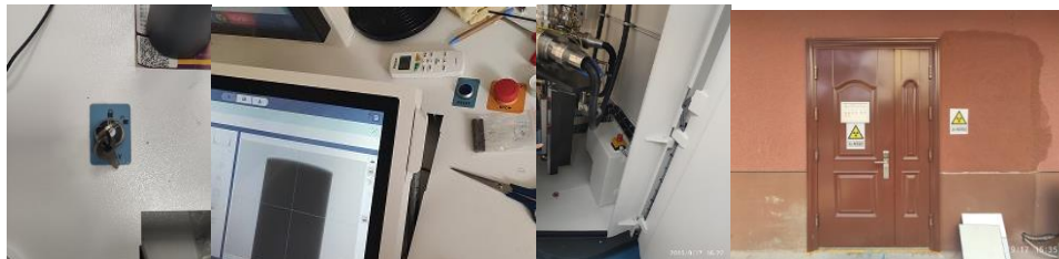
操作台开关 操作台急停 铅房内急停 无损检测室东门
